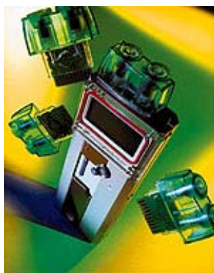
Figura 1.23. Prototipo de chip de DNA portátil y operado por baterías diseñado por CMS
