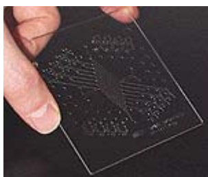
Figura 1.25. Tarjeta plástica rígida de un sólo uso fabricada por Aclara Biosciences Inc. (LabCard™).
