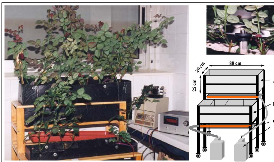
Figura 2.13: Fotografia i esquema del contenidor emprat per fer les mesures. Detall de la cel·la a punt de ser inserida en un medi hidrònic de rosers.
