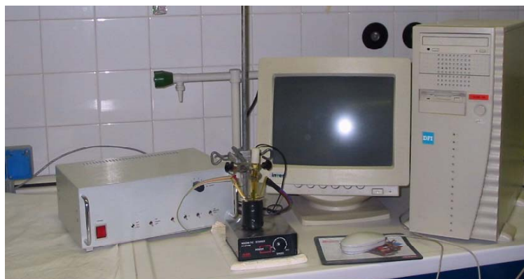
Figura 2.11: Instrumental emprat per a realitzar les mesures amb els ISFETs.
