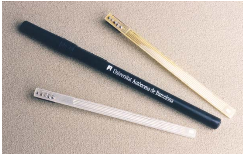
Figura 2.8: Fotografia d'un ISFET subministrat pel IMB-CNM, ja encapsulat i fixat en la tira. Les dimensions de la tira són de 7 x 110 mm.
