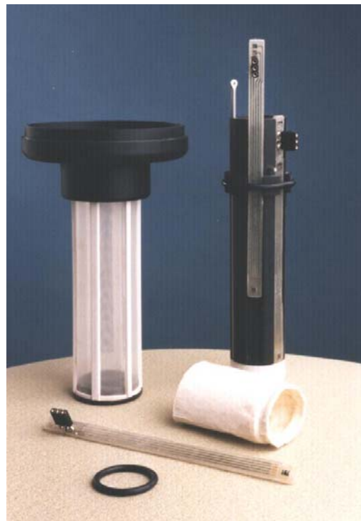
Figura 2.12: Fotografia de les part fixa i mòbil de la cel·la multiISFET.
