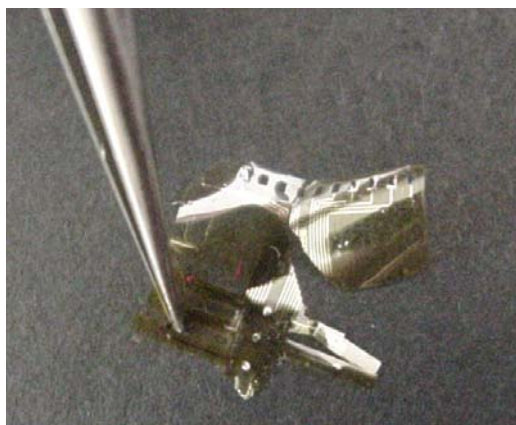
Figura 3.21: Fotografia d'un elèctrode que ha suportat tensions longitudinals.
