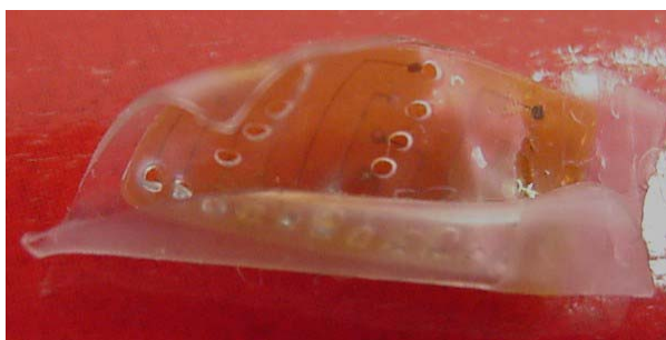
Figura 3.28: Elèctrode de poliimida encapsulat entre dos planxes de silicona.
