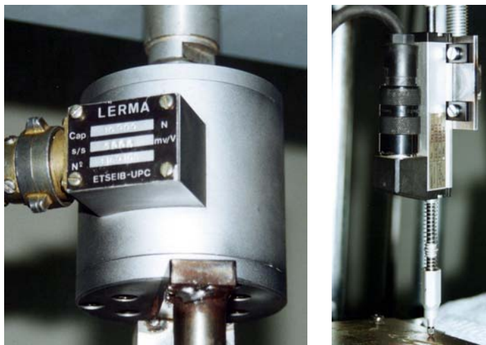
Figura 33. Captadores de fuerza y desplazamiento
