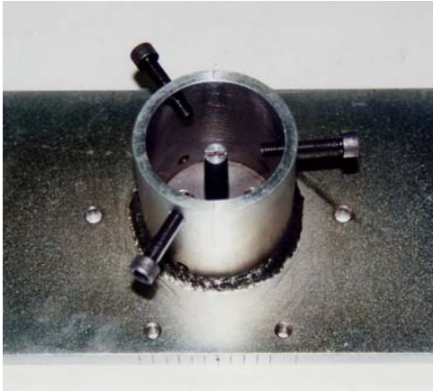
Figura 37. Sistemas de anclaje extramedular ( cazoleta ) y endomedular ( centradores)
