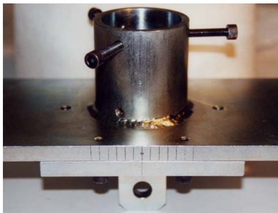
Figura 36. Cazoletas y sistema de calibración de posible excentricidad.
