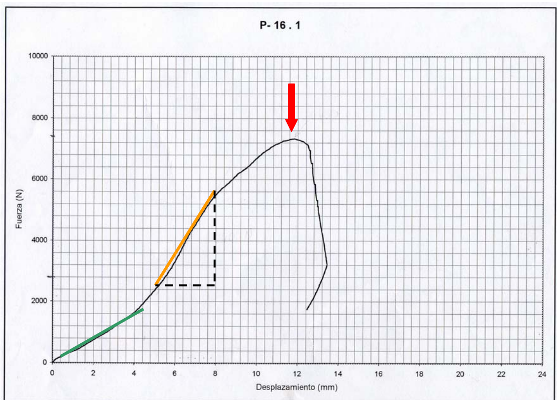
Figura 40. Gráfico de fuerza-desplazamiento, con 2 pendientes de la curva: Zona I representada por la línea verde y Zona II por la línea naranja. El pico máximo de fuerza se señala por la flecha roja.
