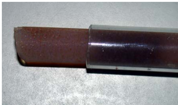
Fig. 2.9. S'ha deduït l'existència de macroporositat en els aerogels en que s'empra \text{FeNa(EDTA)} \cdot 2\text{H}_2\text{O} com a precursor de l'òxid de ferro, la fotografia correspon a la síntesi B1-JNCS.
