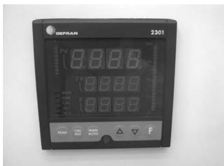
Fig. 140.- Contrôleur P.I.D Gefran 2301 sur le four SiC JIPELEC.
