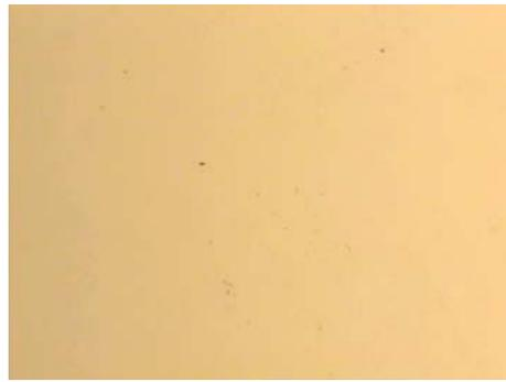
b) Implanté 600°C – recuit 1650°C N<sub>2</sub>
