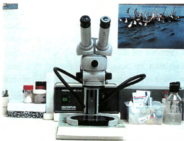
FIG. 25. Microscopi estereoscopi (lupa binocular) Zeiss™, i llum freda Olympus™, per procedir a la dissecció dels hostes.
