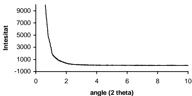
Figura 22. Raigs X en pols corresponent al catalitzador S5Pd recuperat.
