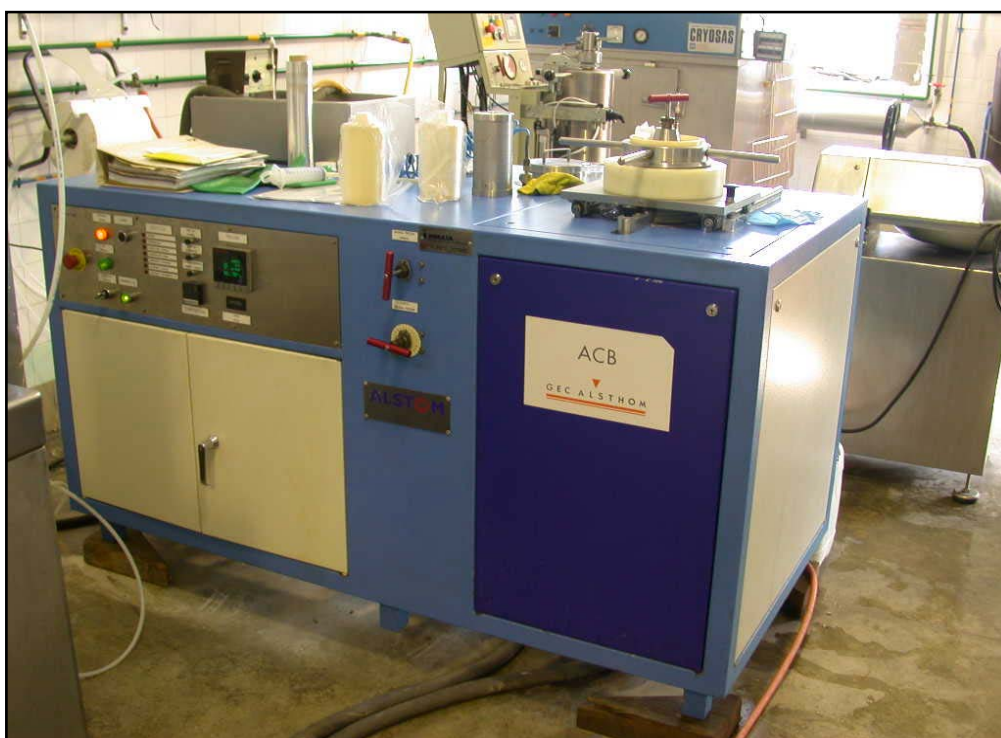
Figura III. 2. Equipo discontinuo de altas presiones (ACB, Nantes, Francia) del Centre Especial de Recerca Planta de Tecnologia dels Aliments (CERPTA).
