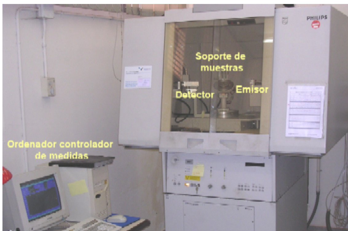
Figura 2.6: Esquema de un goniómetro de 4 círculos.
