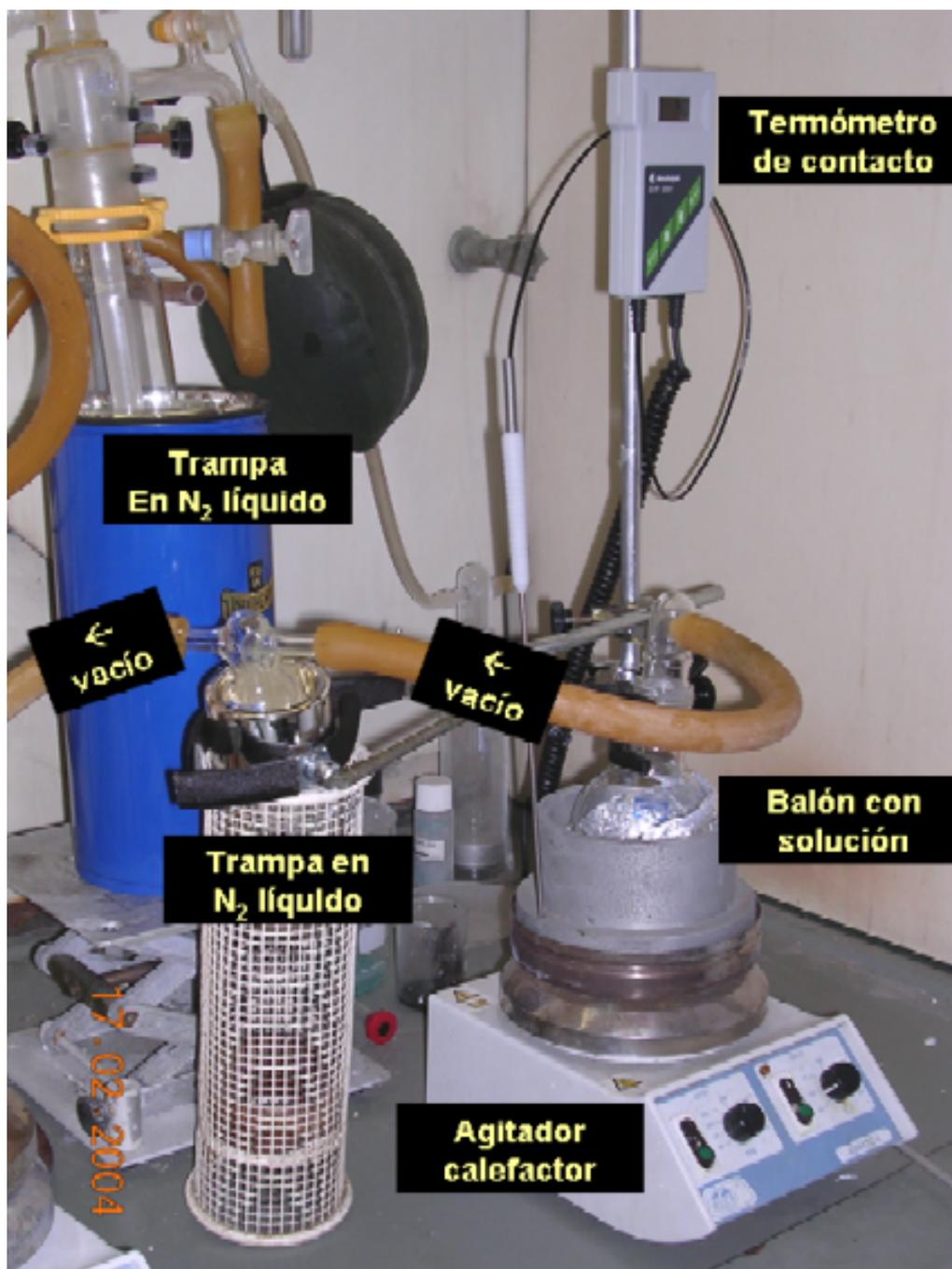
Figura 3.48: Imagen del dispositivo experimental para la purificación de una solución precursora de trifluoroacetatos Y, Ba y Cu (método SIG).
