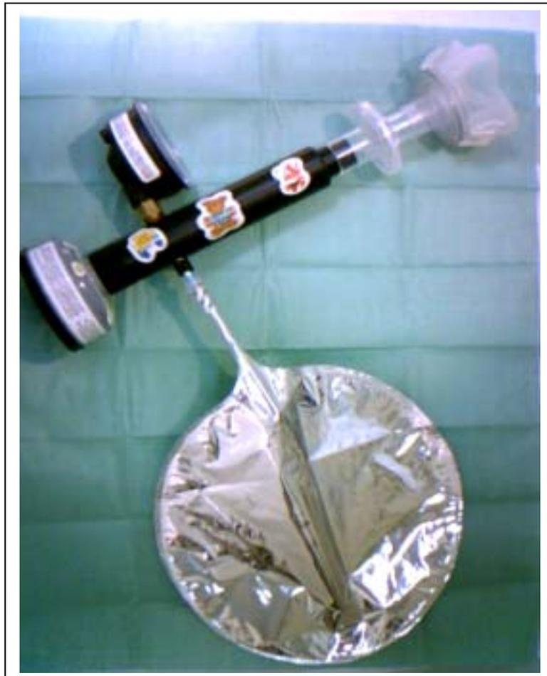
**Figura 11.-** Instrumento de recogida de muestras de aire exhalado
