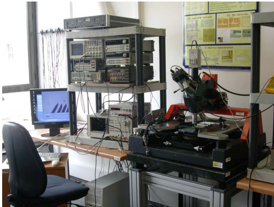
Figura 4.33 Imagen del montaje experimental utilizado para realizar las medidas de caracterización eléctrica.
