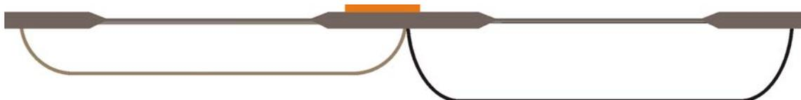
**Figura B. 3** Depósito de polisilicio, nivel poly0, para crear condensadores
