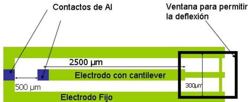
**Figura 6.4** Vista superior de la estructura en silicio, indicando la apertura que permite la deflexión de la palanca y la entrada del líquido y los contactos de aluminio. Las dimensiones finales varían ligeramente.
