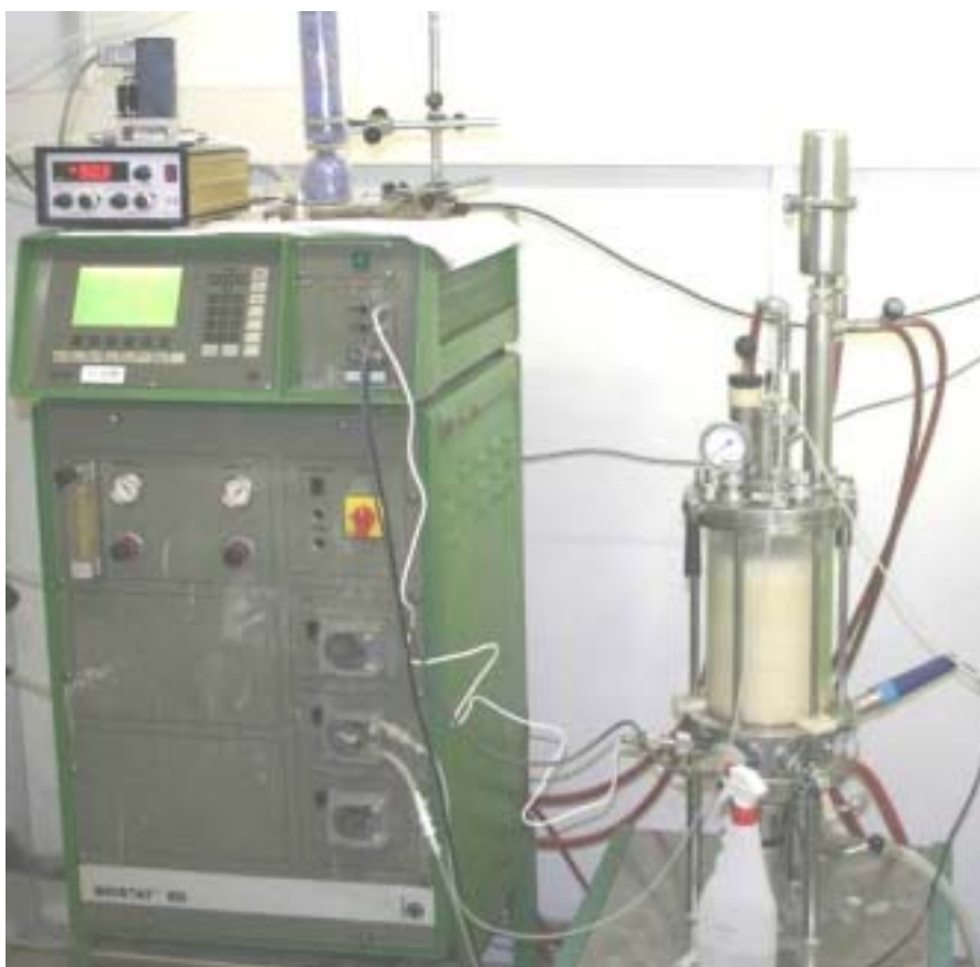
Figura 3.1. Vista del fermentador B.BraunBiostat ED en funcionament.
