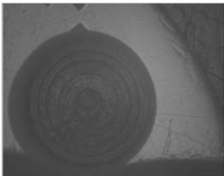
Figura I—18: Microbiopsia de un espécimen para la medida de absorción de fluoruro
