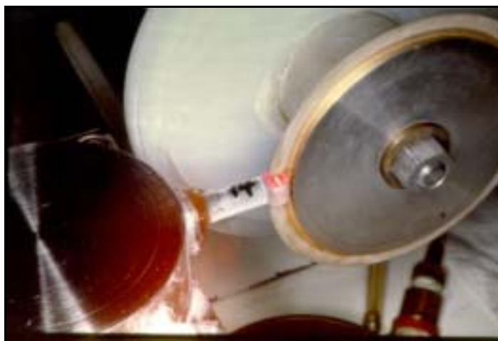
Figura I—19: Corte transversal de una muestra con un microtomo de alta precisión.
