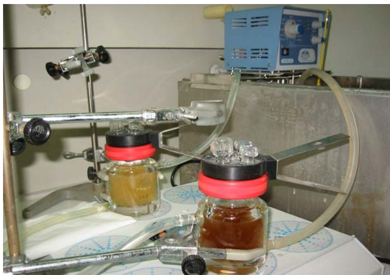
Fig. 2.17. Muntatge experimental per a la hidròlisi d'oligosacàrids amb enzim en dissolució.
