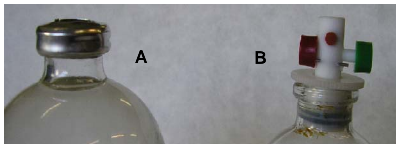
Figura 4.1. Taps folrats amb tefló, (A) senzills i (B) amb vàlvules de tancament
