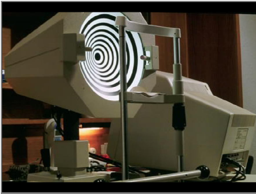
Ilustración II-20 Topógrafo corneal Eye Sys, basado en reflexión de miras (tipo Plácido).
