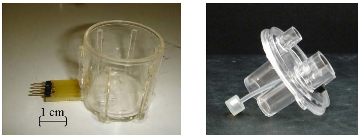
Figura 4.23 Fotografia del muntatge experimental per a la realització de mesures d'impedància a l'interior d'un sistema de cultiu en minibioreactor. A l'esquerra trobem el minibioreactor modificat amb els microelèctrodes situats a la superfície de cultiu i a la dreta trobem la tapa que conté un pèndol magnètic per a l'agitació del medi.
