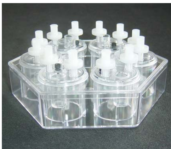
Figura 8.2 Fotografies del sistema de monitoratge i control del cultiu de cèl·lules animals Hexascreen® (esquerra), amb el corresponent plàstic de cultiu de 6 minibioreactors (dreta).
