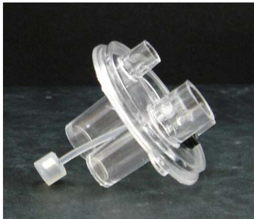
Figura 3.9 Tapa del minibioreactor amb la presència d'un pèndol d'agitació per una correcta homogeneïtzació del medi de cultiu.
