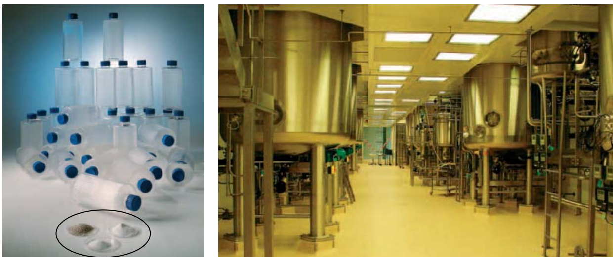
Figura 5.21 Comparació de les necessitats d'un sistema de cultiu en monocapa estàndard (ampolles rodants, esquerra), amb la quantitat de superfície equivalent obtinguda mitjançant tres tipus de microsuports (cercle, esquerra). Planta pel cultiu de cèl·lules vero en microsuports per a la producció de vacunes (dreta). (Amersham·2005)
