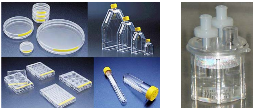
Figura 3.2 Sistemes de cultiu d'un sòl ús estàndards pel cultiu de cèl·lules animals adherents (esquerra). Sistema de cultiu en minibioreactor d'un sòl ús pel cultiu de cèl·lules animals adherents (dreta), que conté ports per a la implementació de sondes pel monitoratge en línia de variables clau dels cultius cel·lulars.
