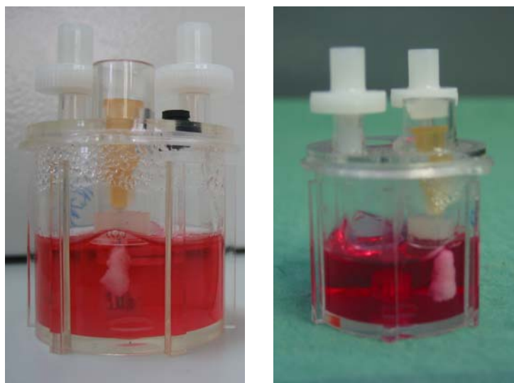
Figura 6.24 Fotografies del sistema de colonització d'un polímer de PLGA a l'interior d'un minibioreactor.
