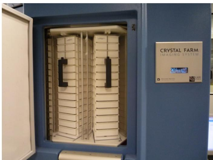
Figura 3.17. Robot de almacenaje y visualización de placas de cristalización Crystal Farm (Bruker AXS).
