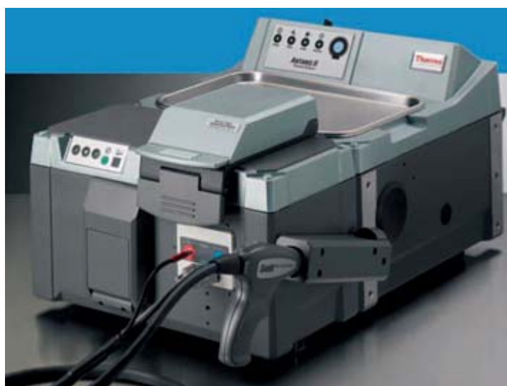
Figura 7.1. Equipo FT-Nicolet Antaris II NIR analyzer
