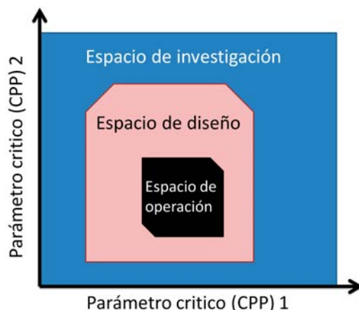
Figura 3.8. Esquema delimitando al espacio de diseño (DS), todo cambio al interior de el no es considerado cambio y no afecta el rendimiento del proceso, el espacio de investigación (IS) son las condiciones de experimentación iniciales y el espacio de operación (OS) reúne las condiciones en las que se lleva a cabo el proceso.
