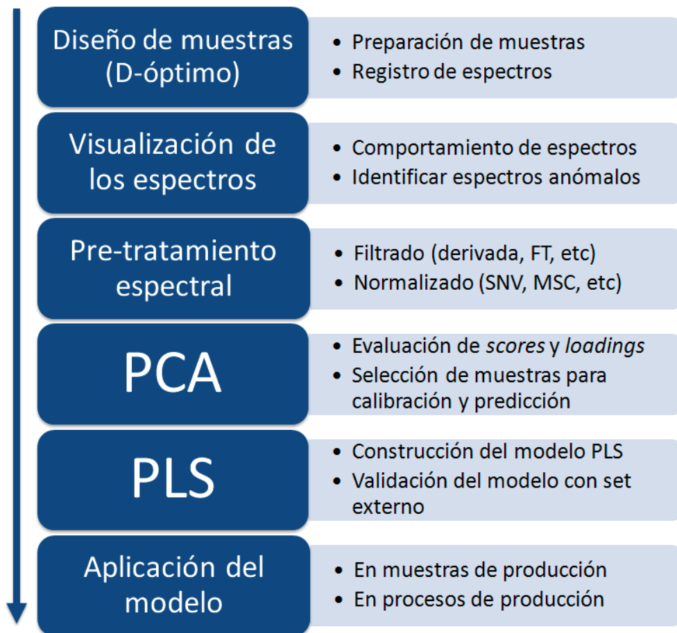
Figura 2.5. Pasos a seguir para obtener modelos de calibrado multivariante robustos
