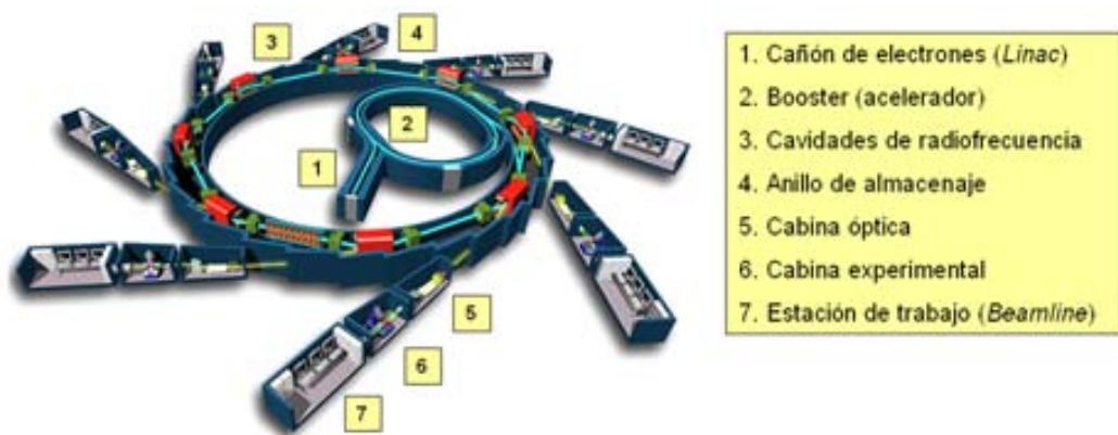
Figura 2.1.7 Esquema de los componentes de un sincrotrón.
