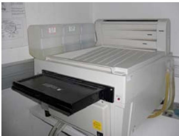
Figura 94. Máquina de revelado FPM-100<sup>a</sup>.
