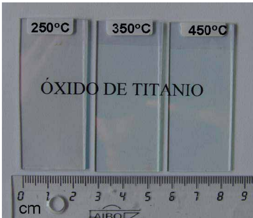
Figura 3.3 Capas de \text{TiO}_2 obtenidas por spin coating.
