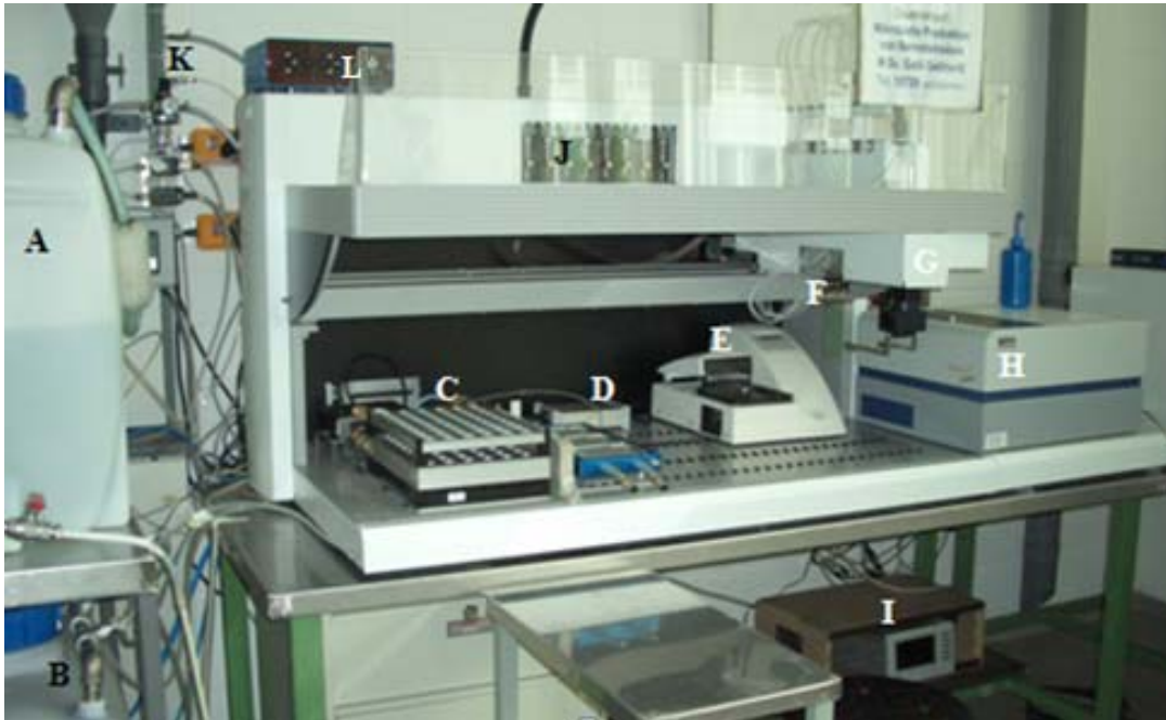
Figura 4.10: Diferents unitats implicades en el sistema de treball de 48 milibioreactors (laboratori de recerca a la Universitat tècnica de Munich).
