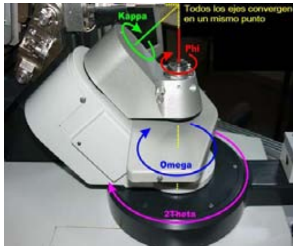
Fig 3.18_ Imagen de un goniómetro mini-Kappa donde se muestra la rotación de los diferentes ángulos. 2\theta varía en la base del goniómetro, el ángulo \omega rota perpendicular al plano del goniómetro; el ángulo del \kappa rota sobre un eje en 50^\circ del eje del \omega ; y, el ángulo \phi sobre el eje de rotación del cristal durante la recogida. Cuando el ángulo del \kappa es cero, se alinean \omega y \phi .
