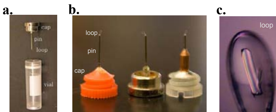
Fig 3.13_ (a) Elementos para pescar y guardar el cristal en nitrógeno líquido. En los experimentos de difracción se utilizaron loops de 20 y 10 micras de grosor. (b) Podemos observar el loop montado sobre diferentes bases (cap). De izquierda a derecha: CrystalCap (de rosca), CrystalCap HT (magnético) -usados actualmente en todas las líneas del sincrotrón- y CrystalCap con base de cobre. Este último se utilizó en los experimentos de difracción de Göttingen ya que la difracción duró varios días y esta base ayuda a reducir la formación de hielo durante la recogida. (c) Cristal montado en el loop. Imagen tomada en el sincrotrón de un cristal de complejo mTERF- \Delta N con DNA 29pb.
