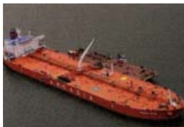
Petrolier. Aquesta mena de vaixells tenen un aspecte exterior molt característic, ja que les màquines, el pont de comandament, l'allotjament i els serveis de la tripulació estan situats a popa. La resta l'ocupen els tancs de petroli.
