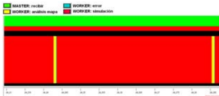
Figura 4.15: Simulación, análisis del mapa simulado y cálculo del error para un individuo.
