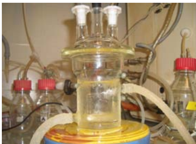
Fig. 9.1. Fotografia de reactor de volum útil 25 mL emprat durant la reacció aldòlica.
