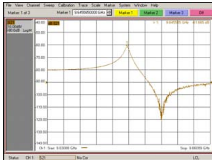
Figura 5.20 Coeficient de reflexió obtingut en l'analitzador de xarxes al connectar la cavitat ressonant amb la caràtula de CD, on la freqüència de ressonància 9.64 GHz s'ha desplaçat respecte la ressonància de referència 10.03 GHz.
