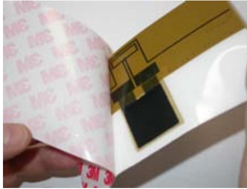
Figura 2.5 Etiqueta semi-passiva amb la bateria integrada i connectada al xip per mitjà d'una xarxa d'adaptació.
