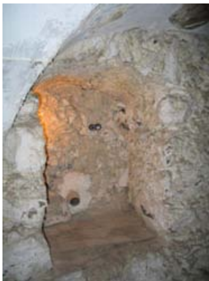
Figura 4.25. El bufador 23, situat a l'interior d'un antic mas, amb detectors de Makrofol a 0.5 m per sobre de la seva sortida mesurant la C_{Rn} a l'aire.
