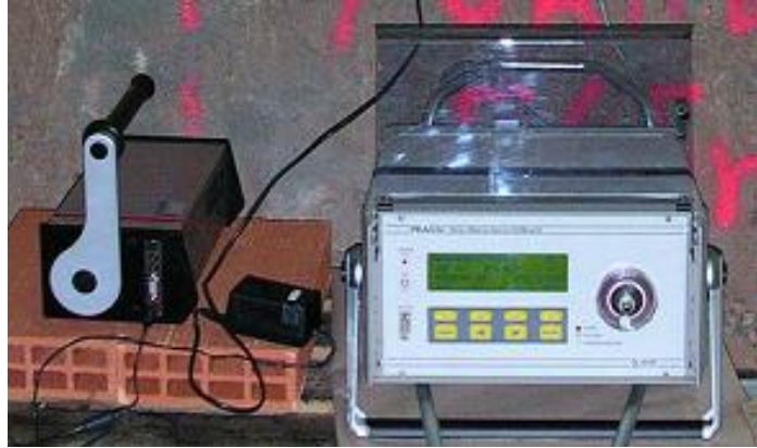
Figura 5.8. Detectores actius (AlphaGUARD i PRASS) mesurant en continu dins d'una cotxera.
