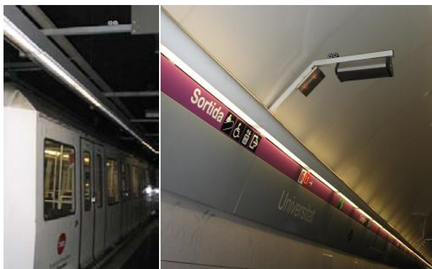
Figura 5.7. Detectors de Makrofol dins de les estacions del Metro de Barcelona.
