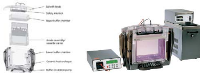
Fig.III.17. Esquema del equipamiento para la 2ª dimensión (EtanDalt six user manual, GE Healthcare).
