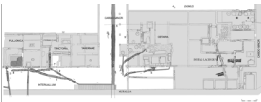
Figura 270. Planimetries de la zona industrial de la Pl. del Rei, amb el gran conjunt de claveguerons que solquen els carrers de l'entorn, construïts esglaonadament amb el temps (BELTRÁN DE HEREDIA, CARRERAS 2011: 237 i 241)
