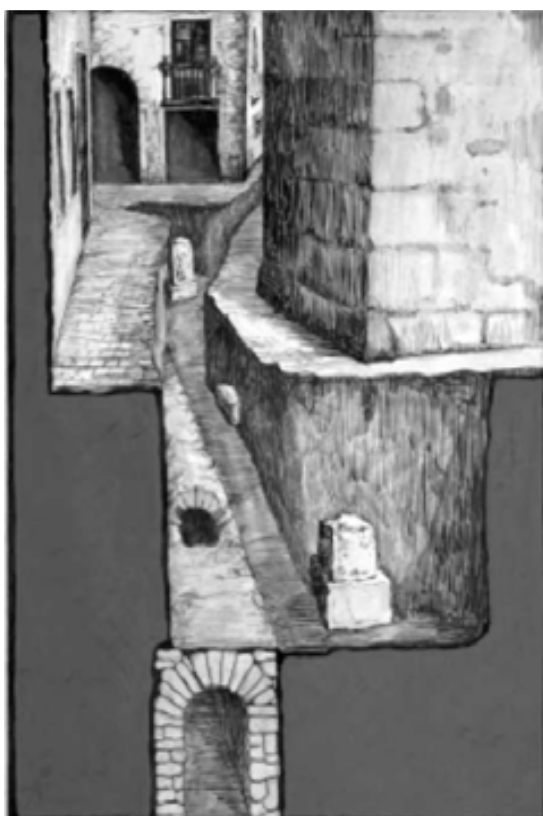
Figura 259. Dibuix de Gudiol del 1928 de la claveguera i els pilars (MIRÓ, ORENGO 2010: 216)
