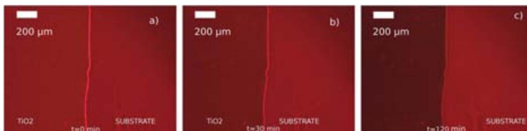
Figura 3.4: Micrografías ópticas de la superficie de una capa de  $\text{TiO}_2$  recubierta con el colorante PDI observada por microscopia de fluorescencia con tiempo de iluminación de 0 (a), 30 (b) y 120 minutos (c).
