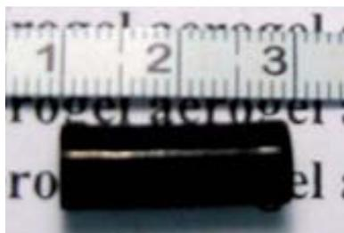
**Figura 8.** Aerogel orgánico obtenido por policondensación del ácido 2,4-dihidroxibenzoico y el formaldehído.
