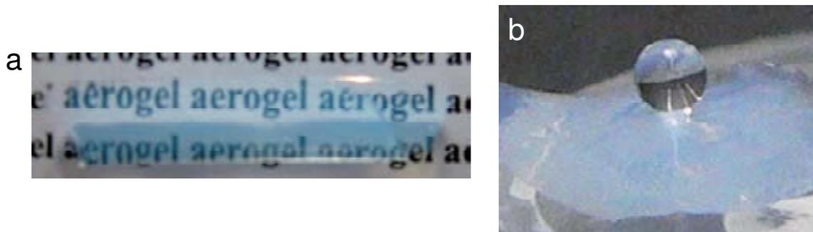
**Figura 7.** a) Aerogel de sílice modificado orgánicamente utilizando como precursores el TMOS y el metiltrimetoxisilano (1:1). b) Gota de agua sobre un aerogel de sílice modificado orgánicamente (hidrofóbico) también utilizando como precursores el TMOS y el metiltrimetoxisilano (1:1).
