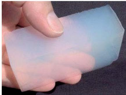
**Figura 1.** Aspecto físico de un aerogel de sílice.
