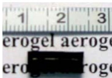
**Figura 9.** Aerogel de carbono obtenido mediante la pirólisis del aerogel orgánico mostrado en la **Figura 8.**
