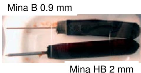
**Figura 4.** Geles **Gel-(s. n.) (3)** con mina B 0.9 mm y con mina HB 2 mm, después del proceso de gelificación. Ambos geles presentan buen aspecto.
