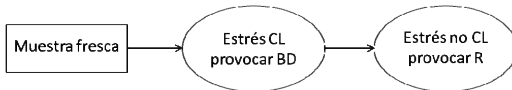
Figura 2-1: Procedimiento de medida para el estudio de la reversibilidad de la ruptura en capacidades MOS. Primero se realiza un estrés con límite de corriente para provocar la ruptura. Después se aplica un estrés sin límite de corriente para inducir la reversibilidad de la ruptura.
