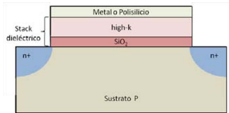
Fig. 1-9: Sección de la estructura de un transistor MOSFET tipo N con dieléctrico de puerta formado por una capa de material high-k sobre una capa de óxido interfacial de \text{SiO}_2 . El grosor de stack dieléctrico resultante es mayor que para una misma capacidad implementada solo con \text{SiO}_2 .
