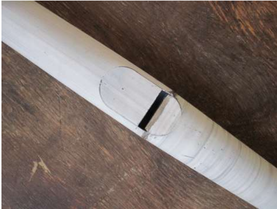
Detalle de la boca del tubo.
