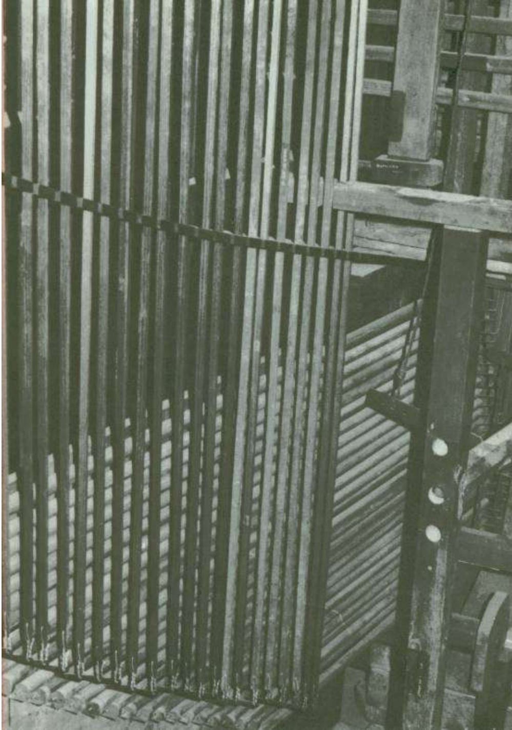
Fig. 40. Catedral de México, órganos del Evangelio, mecanismo para la división de Solo. 117
