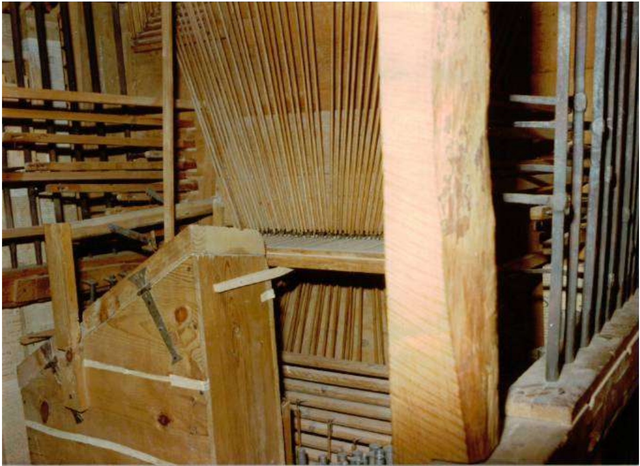
Fig. 19. Liétor, Albacete, España. Acción Suspendida del órgano mayor y Caja de ecos de la Cadereta. 64
