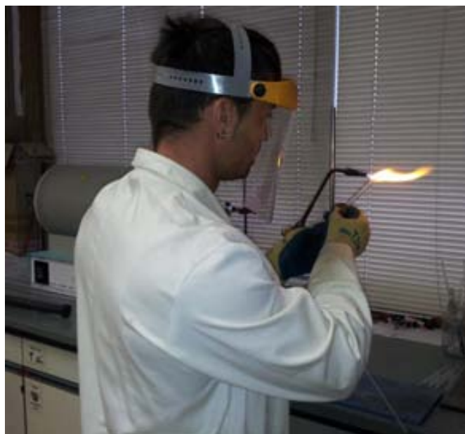
Figura 1.4. Fotografia en el moment de segellar un tub abans de ser introduït al forn, que també es pot apreciar a l'esquerra de la fotografia.
