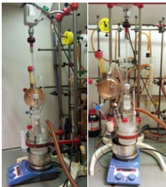
Figura 1.1. Muntatge del sistema per sintetitzar el [B_3H_8] , primera part de la síntesi del [B_{12}H_{12}]^{2-} .
