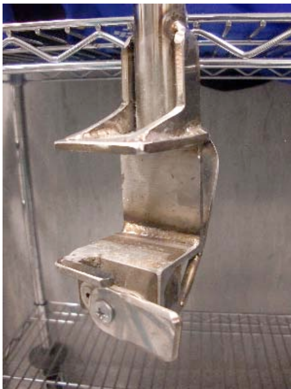
Foto n°5 : Imatge del candau que el servei de manteniment de l'Hospital Universitari Germans Trias i Pujol va dissenyar per tal de fixar cada pal al llit de cada pacient per tal de que aquest es pogués desplaçar fàcilment amb el pacient d'un lloc a un altre i també per evitar el seu robatori.
