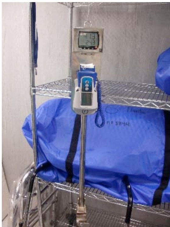
Foto nº3 : Imatge del Pal dels Termòmetres quan no estava fixat en el llit del pacient. En ell podem veure que consta d'una part superior en la que hi ha els termòmetres fixos utilitzats per cada pacient i un pal que en la seva part inferior hi ha la peça que ajuda a fixar-lo en el llit dels pacients. El pal també disposa d'una anell a la part superior per tal de poder-se deixar en el pal dels sèrums quan el pacient entra a l'àrea quirúrgica.
