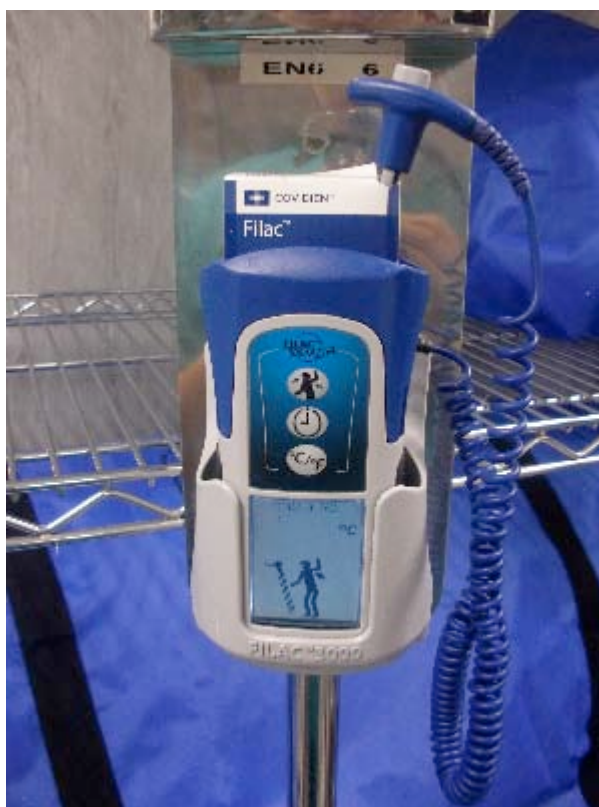
Foto nº2: Imatge dels termòmetres electrònics de la marca Kendall, model FILAC™ 3000AD/ADA (Certificat nº Q2N 07 02 17679 097 / ISO 13485:2003) amb els seus propis recanvis de la funda de la sonda (Certificat nº G1 07 03 17679 101)
