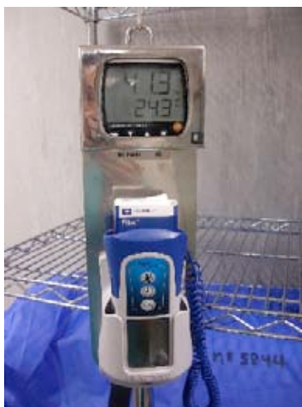
Foto nº4 : Imatge de la part superior del Pal on s'observa el termòmetre ambiental a la part superior que indica la temperatura ambiental i la humitat ambiental, i a la part inferior hi havia collat el termòmetre que s'utilitzava per mesurar la temperatura corporal de cadascun dels pacients. Cada pacient tenia sempre el mateix pal amb els seus termòmetres per tal d'evitar biaixos o errors si s'haguéssin fet servir termòmetres diferents.
