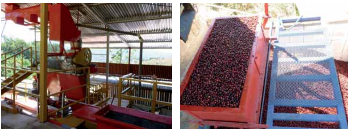
Figura 6.3 Maquinaria estacionaria para despulpado de café (vía húmeda), forma parte del proceso de beneficio del producto (Fuente: Autor)
