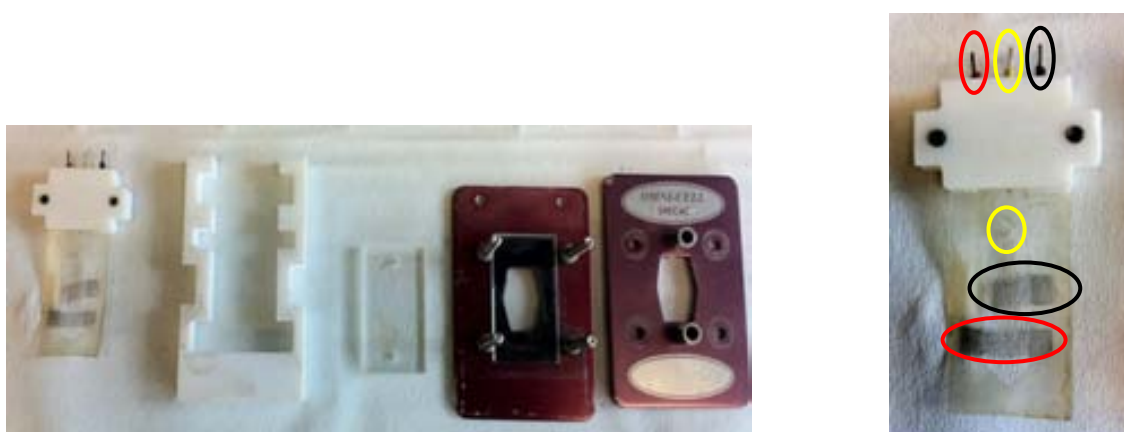
Figura 3.45. A l'esquerra, cel·la d'espectro-electroquímica desmuntada. A la dreta, ampliació dels elèctrodes emprats (negre: treball, groc: referència, vermell: contra-elèctrode).
