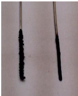
Figura 3.59. Fotografia de dos elèctrodes de Pt amb PPy electrodepositat durant 20 cicles emprant PPy[1] (esquerra) i PPy[25] (dreta) com a agents dopants.
