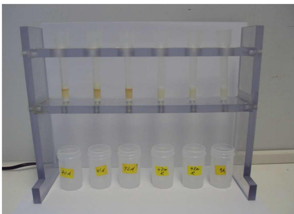
Figura D. Sistemas de columnas de separación específicas para los isótopos de ^{87/86} Sr.
