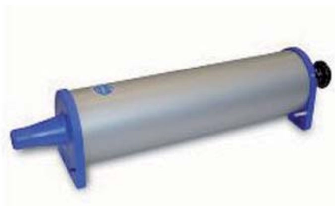
Figura 1.6. Jeringa de calibración de 3 litros.
