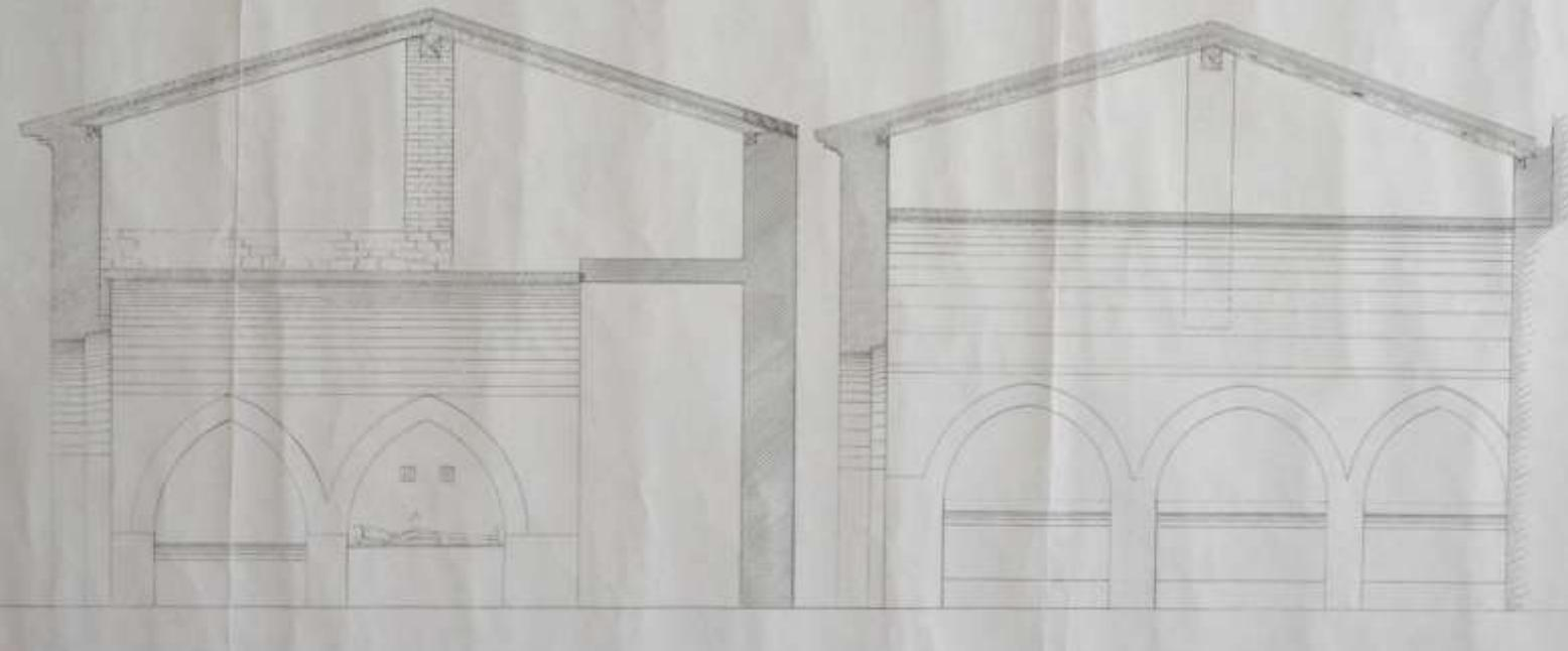
Sección longitudinal de las capillas orientales, SPV, 1890 (AGA); (dibujo: R. Magdalena)
