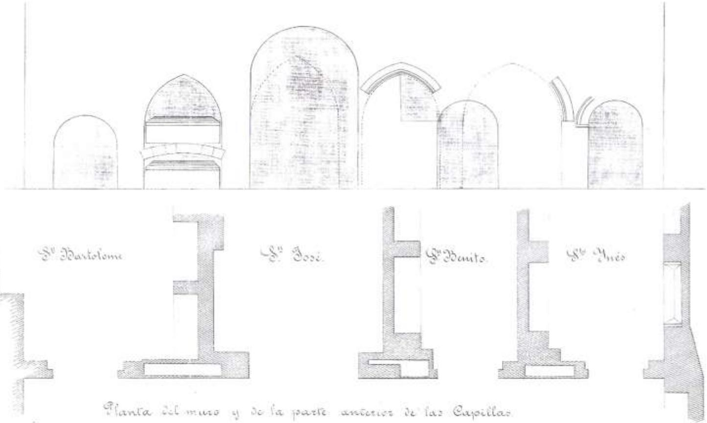
Planta del muro y de la parte anterior de las Capillas
