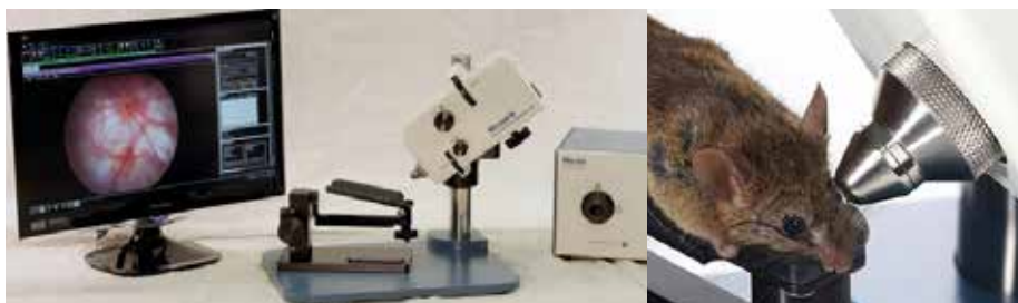
Figura 28. Micron III para realización de NVC. Este sistema permite realizar los impactos de láser guiados por imagen y con un sistema de contacto.
