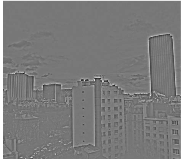
Fig. 7: Efecto de eliminar las frecuencias espaciales bajas (filtro de paso alto), con aplanamiento de la dinámica de la imagen (foto cortesía de Zeiss).
