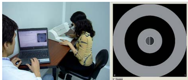
Fig. 11: El dispositivo C-Quant (Oculus), con el instrumento estimulador y un ordenador con el programa de control. A la derecha, el campo de prueba con el anillo que origina la STL (aquí apagado) y el disco central dividido en dos mitades. El sujeto escoge un lado pulsando unos botones.
