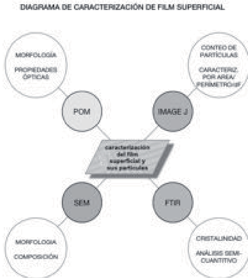
Figura 30. Diagrama de equipos y métodos instrumentales elaborado para la caracterización del film superficial del enlucido de cal en pasta pintado al fresco.
