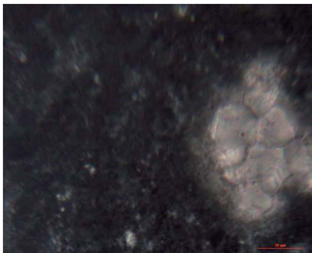
Figura 40. Imagen obtenida a 1.000x XP a los 30 minutos de ejecución del fresco.
