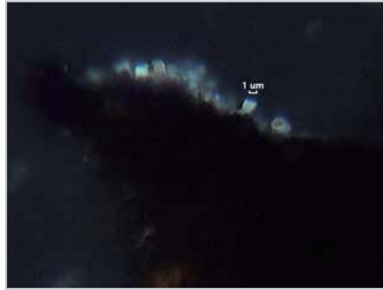
Figura 27. Imagen a x1000 XP. Probeta de 8 años. Cristales euhédricos de calcita que han precipitado por encima de las partículas de pigmento aplicadas en pincelada densa.
