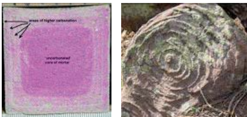
Figura 15. Anillos de Liesegang en la superficie de una probeta de mortero (imagen extraída de Lawrence, 2006 38 ) y su desarrollo en una piedra arenisca 39 .
