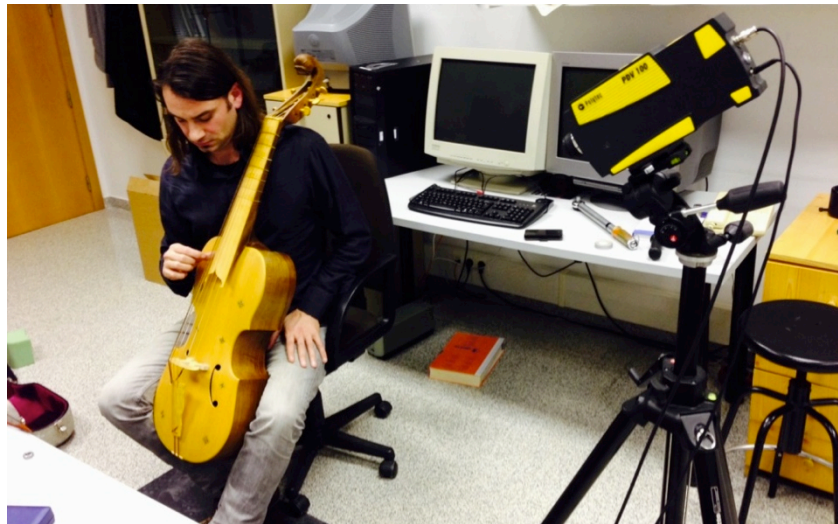
Figura 64. Proceso de medición de vibraciones en la zona del puente de la viola al pulsar la cuerda
