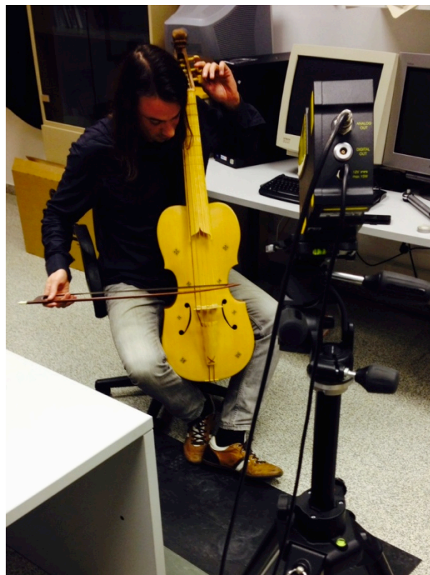
Figura 65. Proceso de medición de vibraciones en la zona del puente de la viola al tocar con el arco la cuerda
