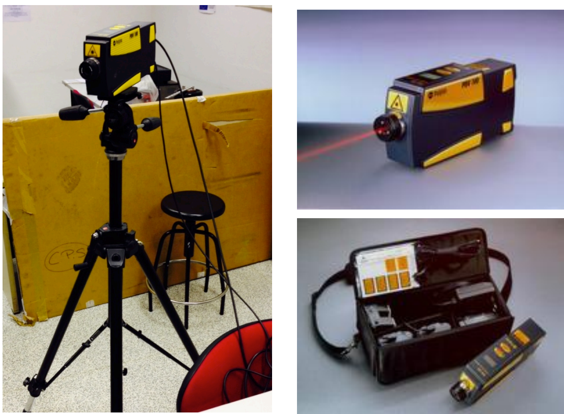
Figura 63. Vibrómetro láser digital Polytec PDV 100 utilizado para la medición de vibraciones sin contacto en el puente de la viola
