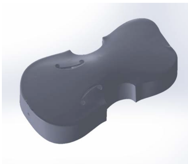
Figura 48. Modelo CAD 3D de la vihuela utilizado para el análisis modal de su estructura
