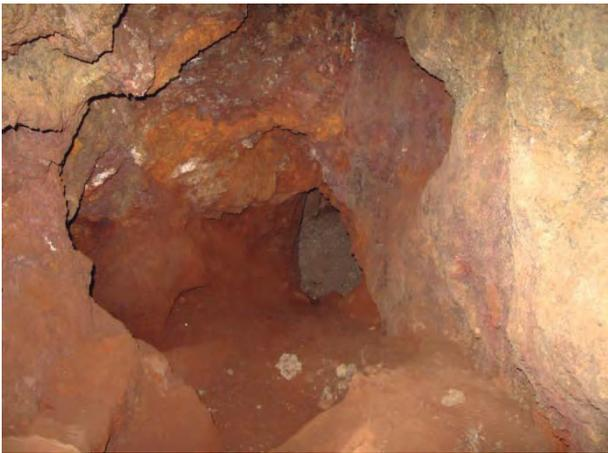
Figura 7.2. Vista del interior del socavón 1 con impregnaciones de hidróxidos de hierro en el techo.
