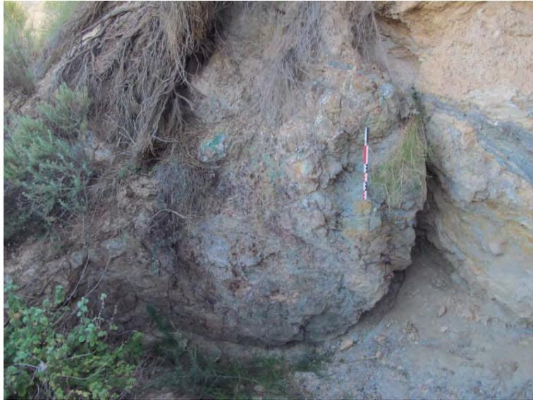
**Figura 82.1. Calicata en el contacto entre mármoles y esquistos con impregnaciones de malaquita.**
